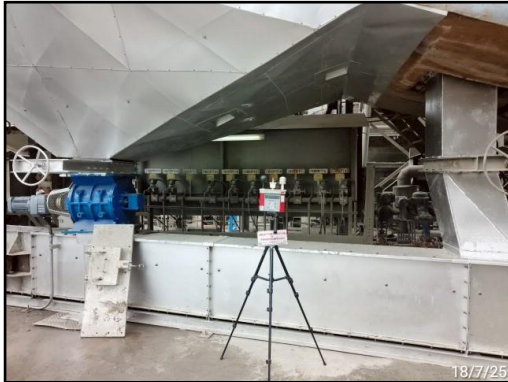
ภาพที่ 3.56 การตรวจวัดความร้อน บริเวณ AQC 5 Boiler ชั้น 2
