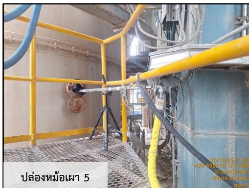
ภาพที่ 3.17 การตรวจวัด HCl, HF จากปล่องหม้อเผา
