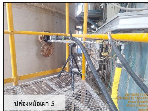
ภาพที่ 3.18 การตรวจวัด TOC จากปล่องหม้อเผา
