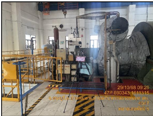
ภาพที่ 3.47 การตรวจวัดระดับเสียงของเครื่องจักรบริเวณกังหันไอน้ำ
